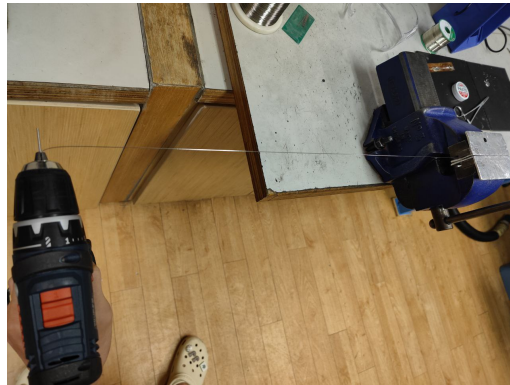
(d) Maintain tension while coiling
